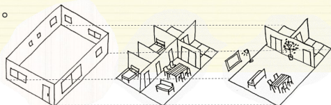
・仕切りを壊って部屋を増やしたり ・仕切りを取って大空間LDKを造ったり
